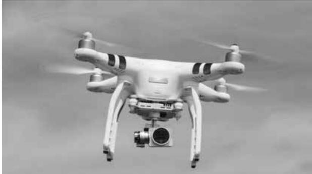
*Drohne mit montierter Videokamera*
