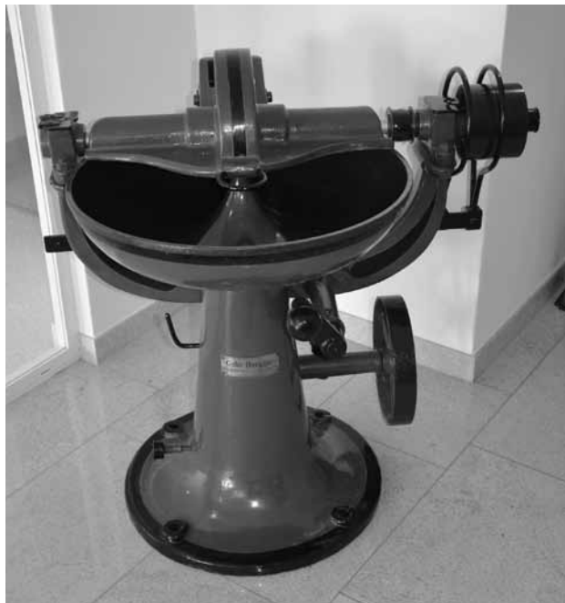
Solch ein Mixer wurde früher bei der Wurstproduktion eingesetzt.
